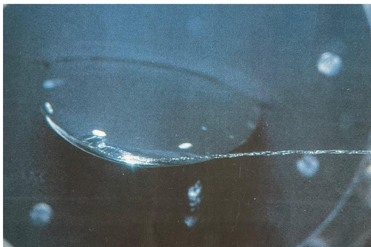
Figure 14 : Tourbillon d'extrémité d'aile [5, p. 29]
