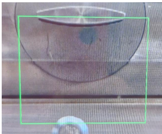
Figure 38 : Mise à zéro du profil horizontalement
