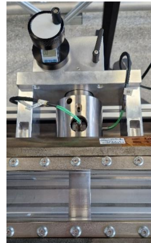
Figure 27 : Vue de dessus du dispositif de rotation du profil
