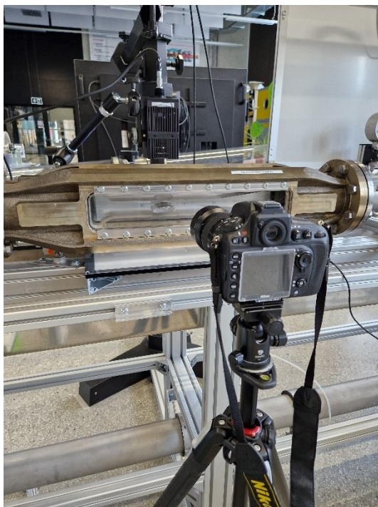
Figure 48 : Setup pour la prise d'image depuis le côté
