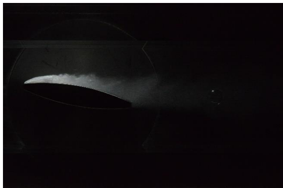
Figure 70 : Image du profil vu de côté. Incidence = 10^\circ et \sigma = 2.8 . Poche de cavitation partielle
